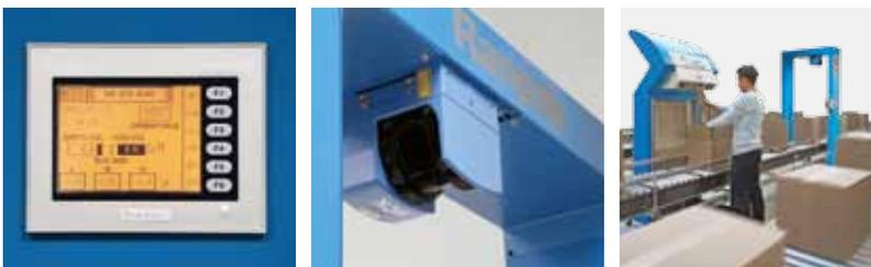
El AccuFill consta de un sistema de medición en línea que determina la cantidad exacta de espacio vacío en una caja de transporte. Luego envía una señal al FillPak para que suministre la cantidad óptima de papel necesaria para llenar el espacio vacío de esa caja específica. Procesando hasta 10 cajas por minuto. Los productos se protegerán durante el envío y llegarán a su destino final sin daños.
