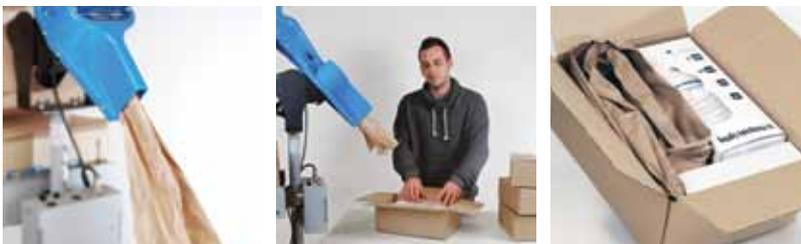
El convertidor moldea papel kraft de una sola capa en una configuración de papel en forma de estrella de gran volumen que se puede utilizar como material de relleno efectivo. Impide que los productos se muevan dentro de la caja, garantizando que lleguen sin daños a su destino final. El convertidor funciona a gran velocidad, es compacto y fácil de integrar en cualquier entorno de embalaje
